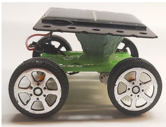
Figura 2: Miniveículo solar educativo, modelo MVS-1 montado com o kit comercial e outros acessórios, como: suporte de papelão para sustentação da célula solar sobre o chassi, capacitor eletrolítico de 25 V e 47 \mu F (que foi conectado eletricamente em paralelo com o motor e a célula solar) e a nova engrenagem com 48 dentes conectada à roda.
