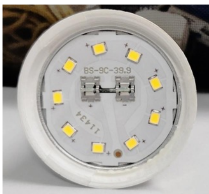
Figura 3: Lâmpada LED de 09 W da marca Ouro Lux, sem o bulbo difusor de plástico, utilizada durante os testes.
