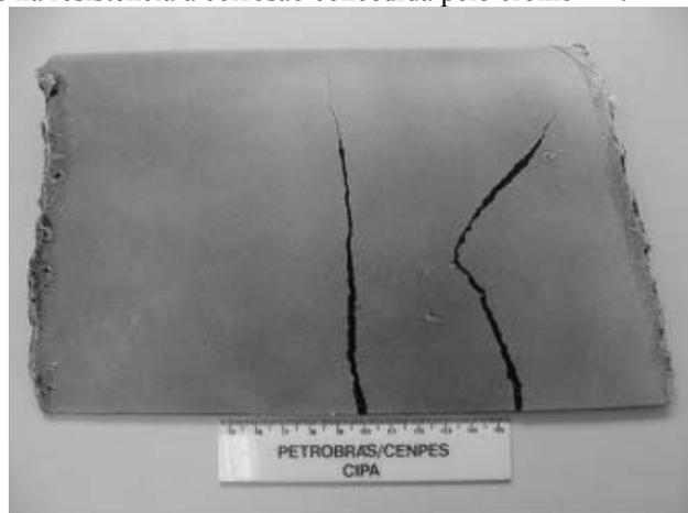
**Figura 1 - Trincas em uma palheta fixa de um turbo expensor de uma unidade de craqueamento catalítico.** Observou-se a formação de um depósito escuro nas superfícies das trincas, cuja composição química qualitativa
