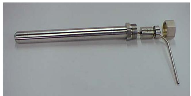
Figure 3 - Partes da célula de ponto fixo projetada e construída, antes da montagem final.
