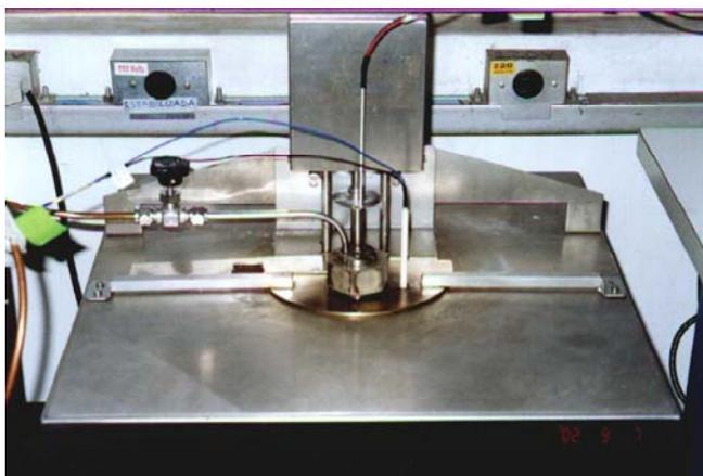
Figure 4 - Fotografia do conjunto da célula instalada no meio térmico para calibração dos sensores.
