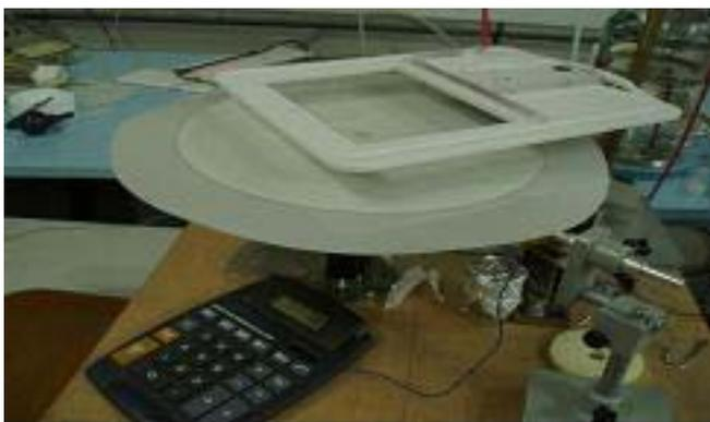
Fig. 2 - Fotografia da montagem experimental. Parte inferior, eletrodo circular aterrado. Parte superior bastidor com eletrodos filamentosos.
