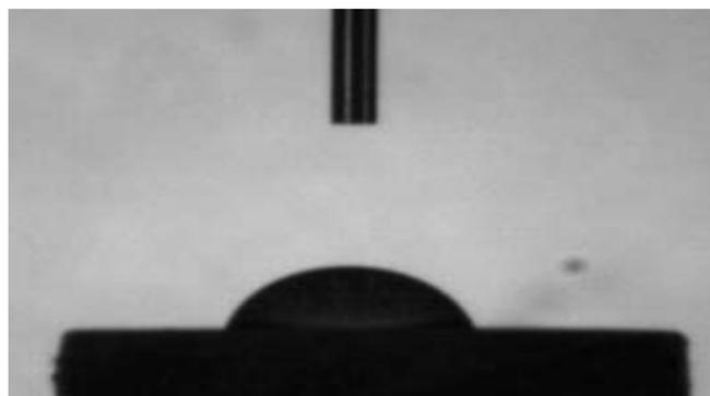
Fig. 6 - Imagem típica obtida para as medidas de ângulo de contato.
