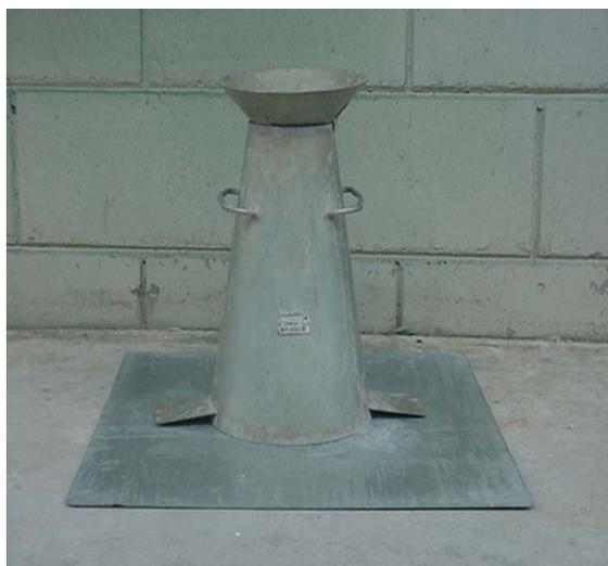
Figura 3 – Ilustração do Cone utilizado no teste de Slump.
