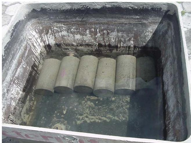
Figura 4 – Ilustração do processo de cura dos compósitos em água.
