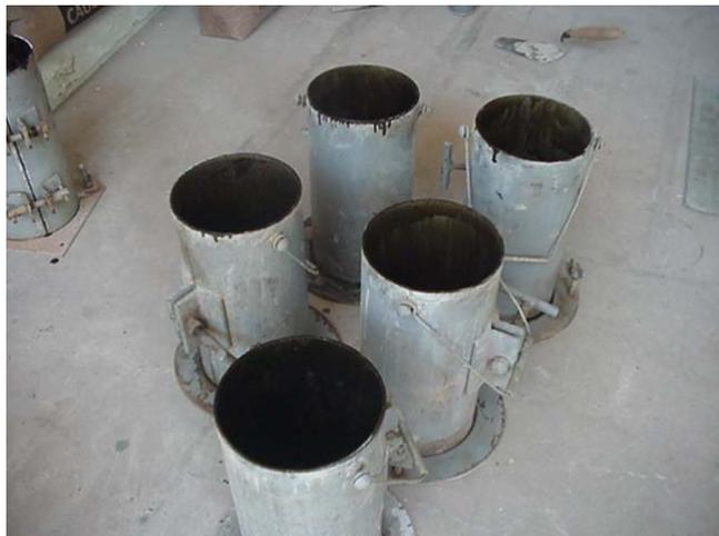
Figura 2 - Molde utilizado na preparação dos corpos-de-prova.
