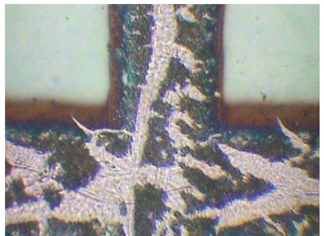
Figura 8 - Detalhe das trincas do substrato.
