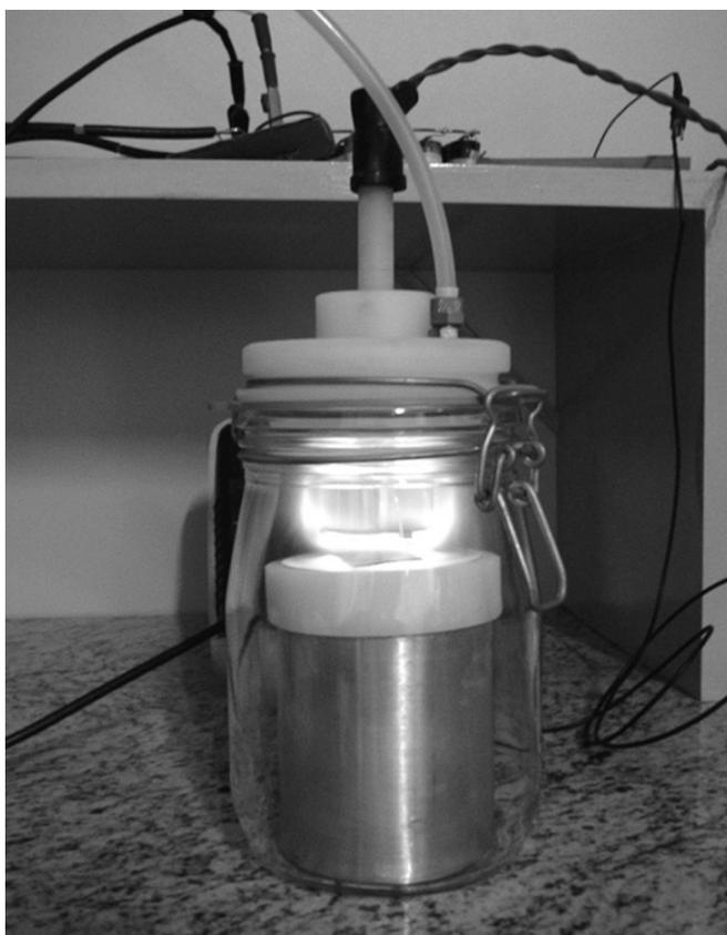
Figura 7 - Foto do pulverizador catódico em funcionamento.
