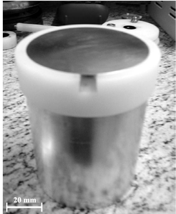
**Figura 3 - Foto do anodo, ilustrando em detalhes o recorte feito para a passagem do fio condutor. A parte superior é a chapa de inox onde é colocado o substrato.**
