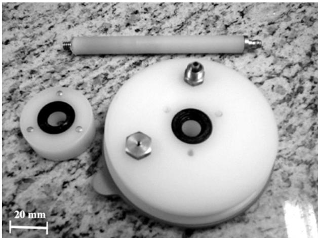
**Figura 2 - Detalhes da montagem da isolamento de vácuo na tampa. Na parte superior da foto vê-se a haste condutora de corrente elétrica para o catodo. A figura ilustra ainda a disposição dos retentores de vácuo (anéis pretos).**
