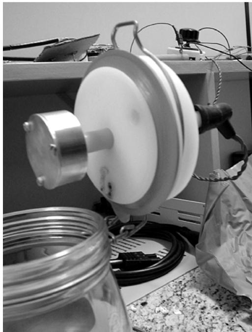
Figura 5 - Montagem final do catodo fixado à tampa.
