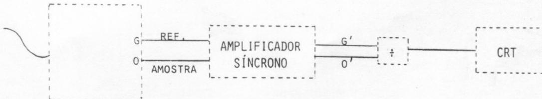
Fig. 2 - Esquema geral do deposímetro, com tratamento de sinais por amplificador síncrono e divisor analógico a tolerâncias da ordem de 0,1%.
