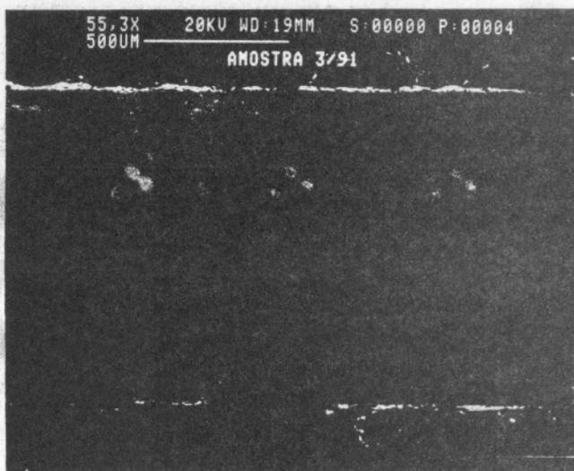
Fig. 3 - Fotomicrografias do nióbio revestido com Si-20Cr-20Fe após tratamento a 1500°C/1 h em hélio
