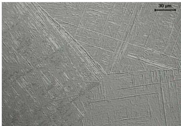
**Figura 5 - Micrografia da liga Ti-6Al-4V com estrutura Martensita.**
