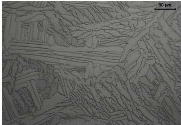
**Figura 4 - Micrografia da liga Ti-6Al-4V com estrutura tipo Widmanstätten.**
