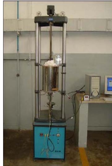
Figura 3 - Forno de fluência marca Mayes.
