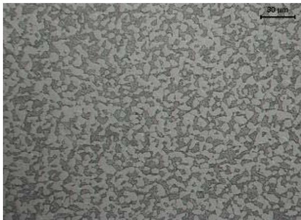
**Figura 6 – Micrografia da Liga Ti-6Al-4V com estrutura Bimodal.**
