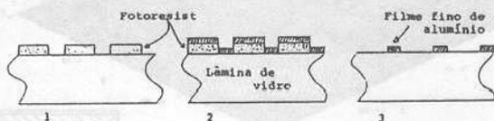
Figura 1- Esquema de preparação do substrato.
