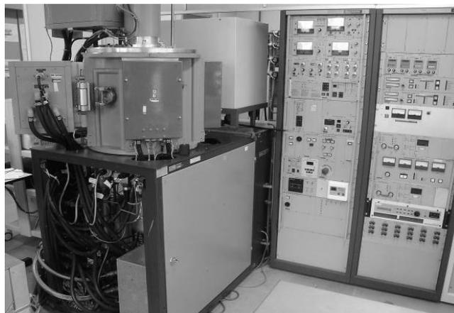
Figura 3 – Ilustração do equipamento Balzers BAS 450MS usado na deposição catódica.
