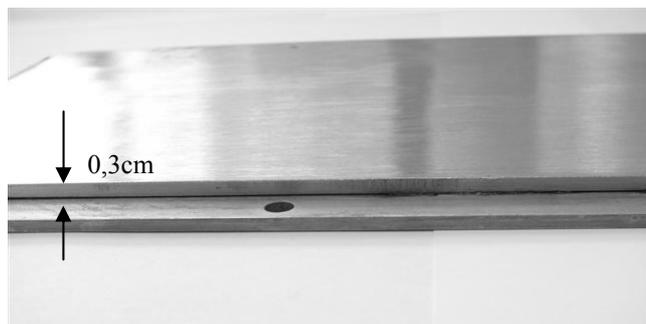
Figura 1 - Alvo de níquel com 0,3cm de espessura acoplado em suporte de cobre.
