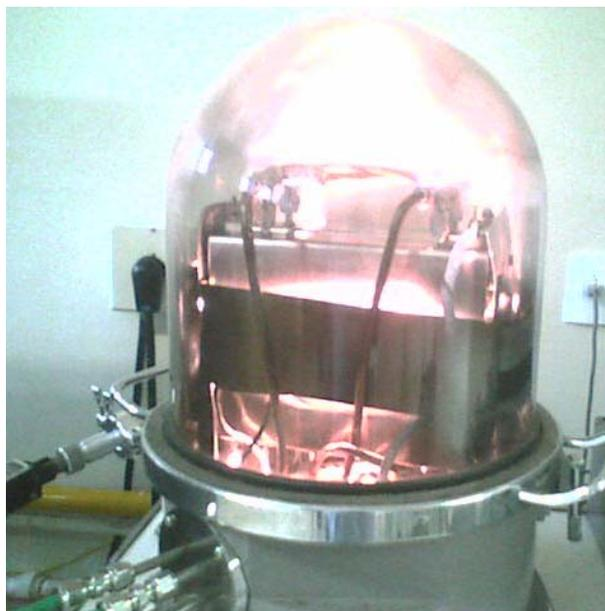
Figura 3 - Fotografia do sistema CSS durante uma deposição.
