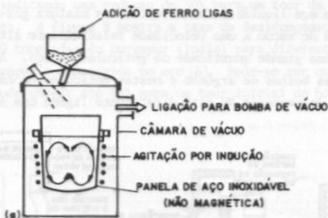
Figura 4 - Desgaseificação na panela.
