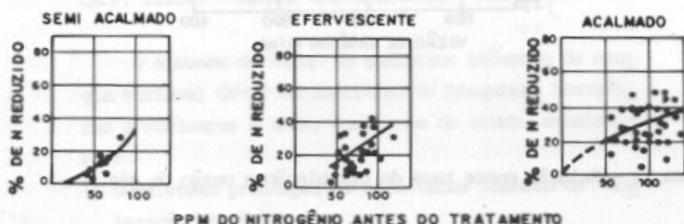
Figura 10 - Taxa de desnitração em função do grau de desoxidação.
