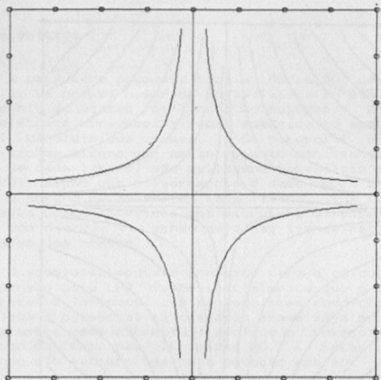
Fig. 2.(a). Equipotencial de 5% de  $V_0$ .
