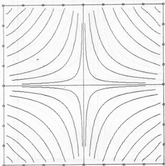
Fig. 1. Curvas equipotenciais calculadas para equipotenciais de 1,5,10,...,70% de  $V_0$ , em uma LPQ com 9 arames por lateral.
