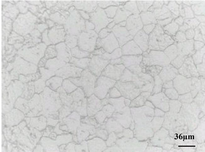
Figura 3.2 - Microscopia óptica (MO), mostrando a microestrutura do aço recozido.
